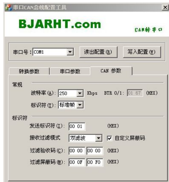
自定义屏蔽码在标准帧类型下的双滤波设置
