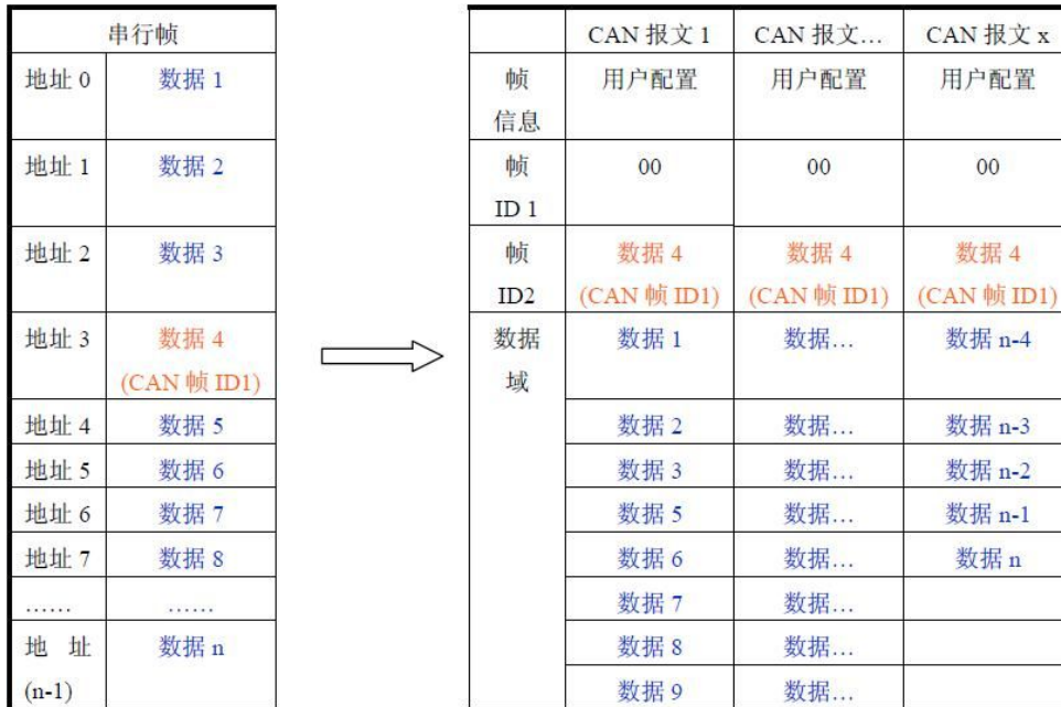
串行帧转CAN报文（透明带标识）
