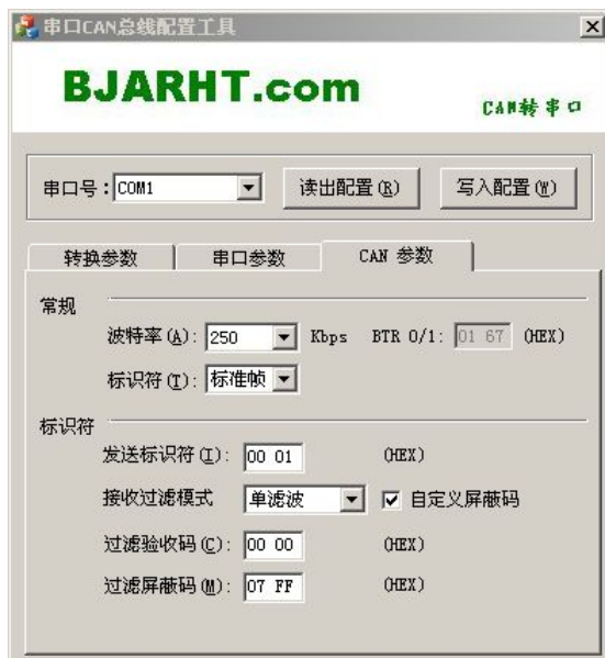
自定义屏蔽码在标准帧类型下的单滤波设置
